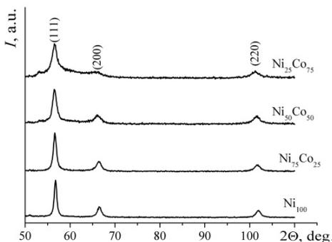
Fig. 1. XRD-patterns of Ni-Co-NPs ( $\text{Fe-K}\alpha$ ).
